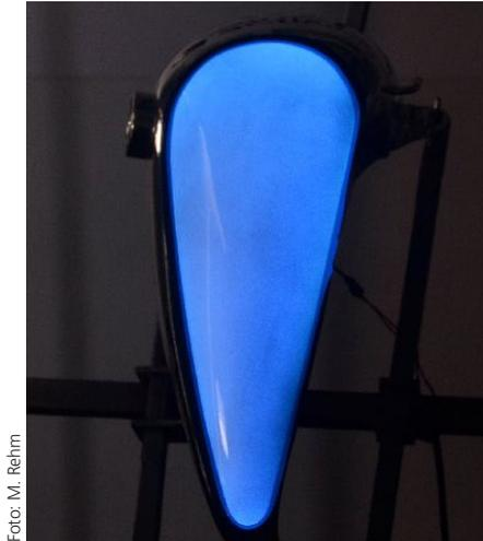
Der partielle Anwendungen wie hier an einem Motorradtank eignet sich ColorTron-Leuchtack perfekt.
